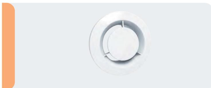
Entièrement réalisées en polystyrène, la bouche BS 80 se monte directement dans le conduit rigide Ø 80 mm, un joint assurant alors le maintien et l'étanchéité ou associée à un manchon placo 3 griffes, à un manchon de traversée de dalle ou un manchon coudé (voir ensembles ci-contre)
