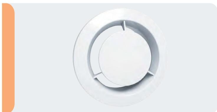
Entièrement réalisées en polystyrène, la bouche BC 125 se monte directement dans le conduit rigide Ø 125 mm, un joint assurant alors le maintien et l'étanchéité ou associée à un manchon placo 3 griffes ou à un manchon de traversée de dalle (voir ensembles ci-contre)
