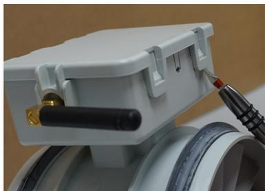
1/ Ouvrir le boîtier à l'aide d'un tournevis plat en décochant les 4 pattes de fixations
