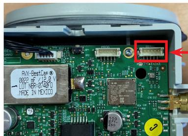
2/ Raccorder le connecteur sur le port « série » de la carte électronique
