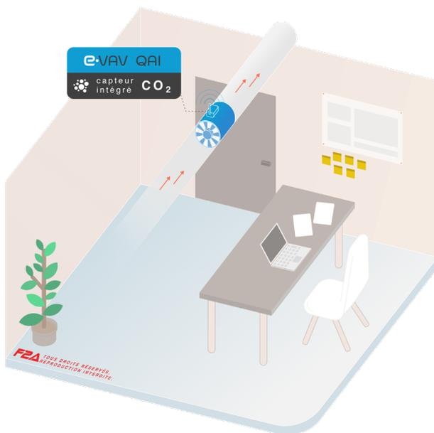
Le registre **e-VAV QAI** à la reprise est piloté par la mesure de CO<sub>2</sub> provenant de son capteur intégré.
