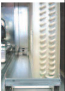
La fonction batterie froide est équipée d'un **bac à condensats amovible à pente intégrée**, pour supprimer la rétention d'eau, il est de type rapporté sur glissière pour un démontage aisé.
